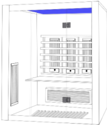
(8) Deckenplatte auf die installierten Platten setzen.
